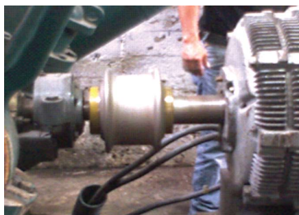
Рис. 5-8. Хотя на тепловом изображении двигателя и сцепления видны тепловые следы с обеих сторон, что может свидетельствовать о проблеме соосности сцепления, на изображении в видимом свете признаков неисправности нет.
