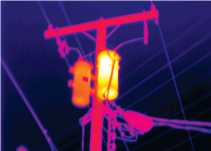
Рис. 5-84. Данное тепловое изображение говорит о том, что в трансформаторе справа может быть неисправность.
