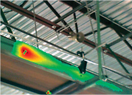
Рис. 5-67. Трение ленты подвешенного конвейера создает перегрев на тепловом изображении. Лента перекашивается из-за изношенного подшипника в ролике. В результате повышенное трение приводит к перегреву приводного двигателя.
