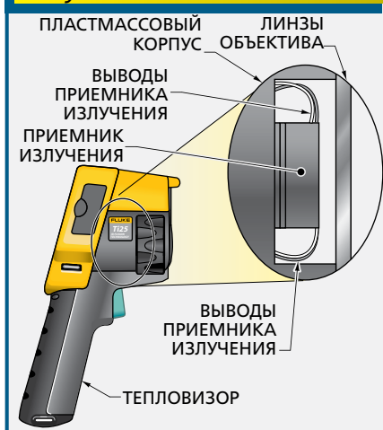
Рис. 1-2. Матричный приемник излучения (матрица в фокальной плоскости, ФПА) – это устройство получения изображения, состоящее из массива (обычно прямоугольного) чувствительных к излучению пикселей, расположенных в фокальной плоскости объектива.
