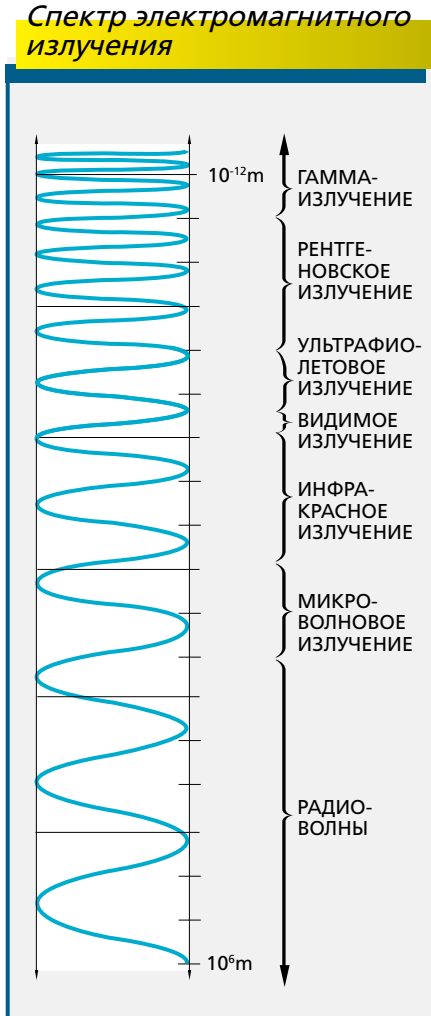
Рис. 4-3. Спектр электромагнитного излучения — это диапазон всех видов электромагнитного излучения, в зависимости от длины волны.
