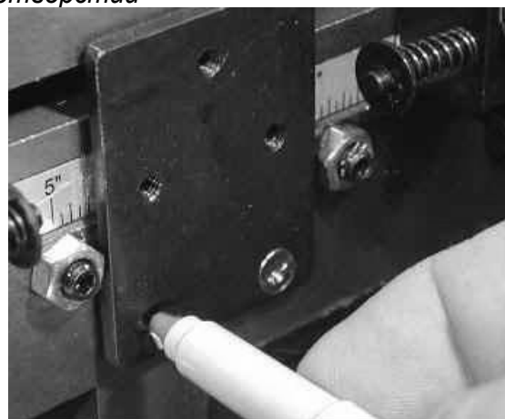
Разметка второго монтажного отверстия
