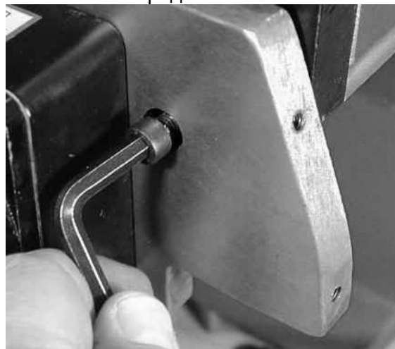
Крепление электродвигателя на столе винтами
