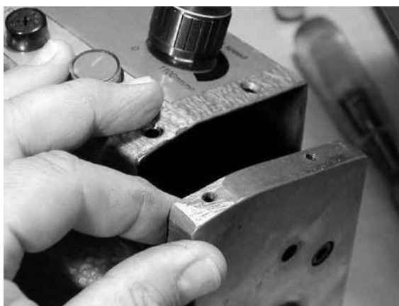
Извлечение пластины с электродвигателем из корпуса
