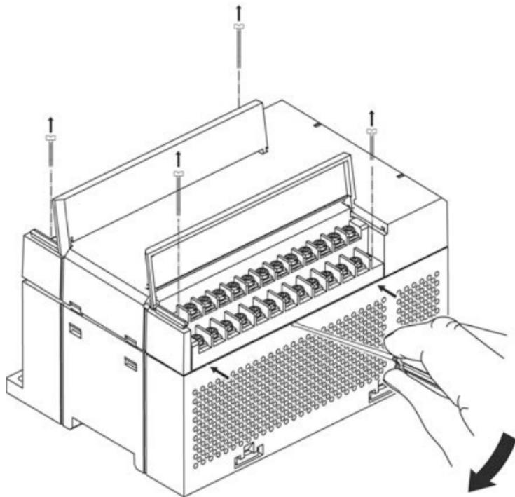
Рисунок Д.1 – Отделение съемных частей клемм MB110-32ДН
