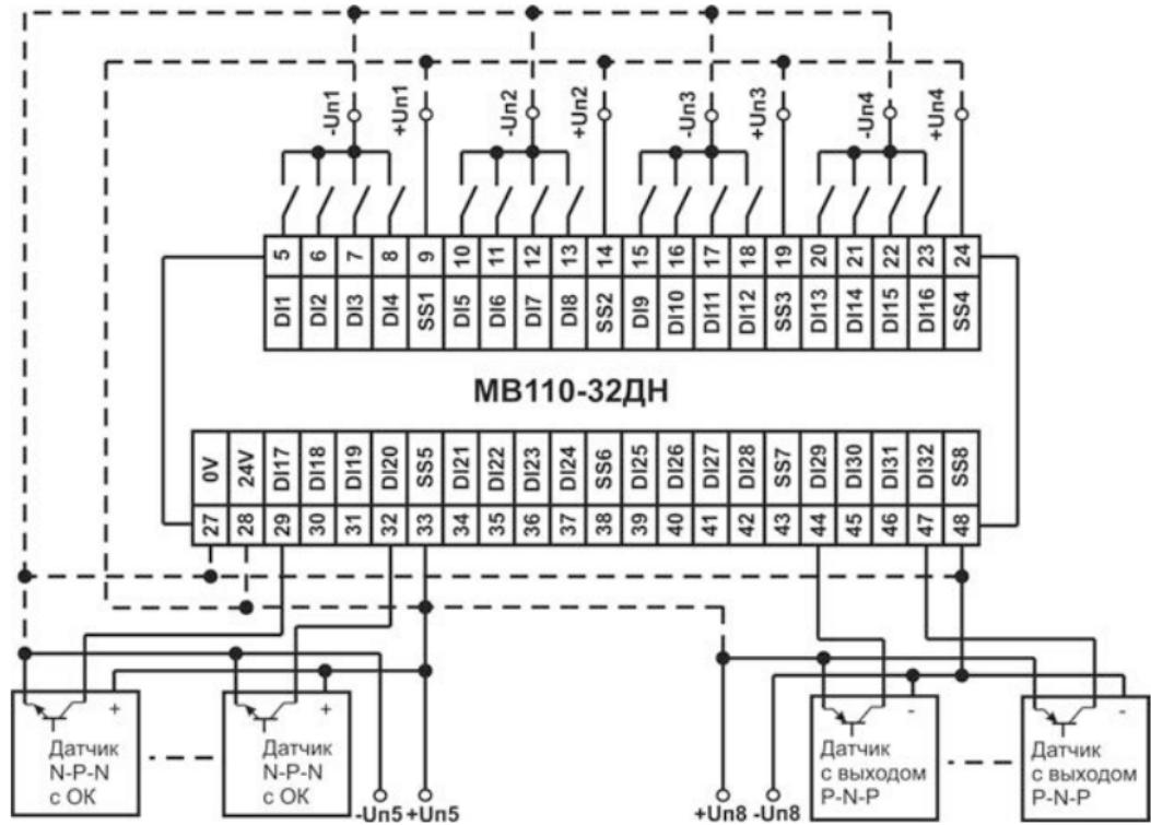
Рисунок Б.5 – Схема подключения к MB110-32ДН дискретных датчиков с транзисторным выходом р-п-р-типа, п-р-п-типа с ОК и с выходом типа «сухой контакт» (пример)
