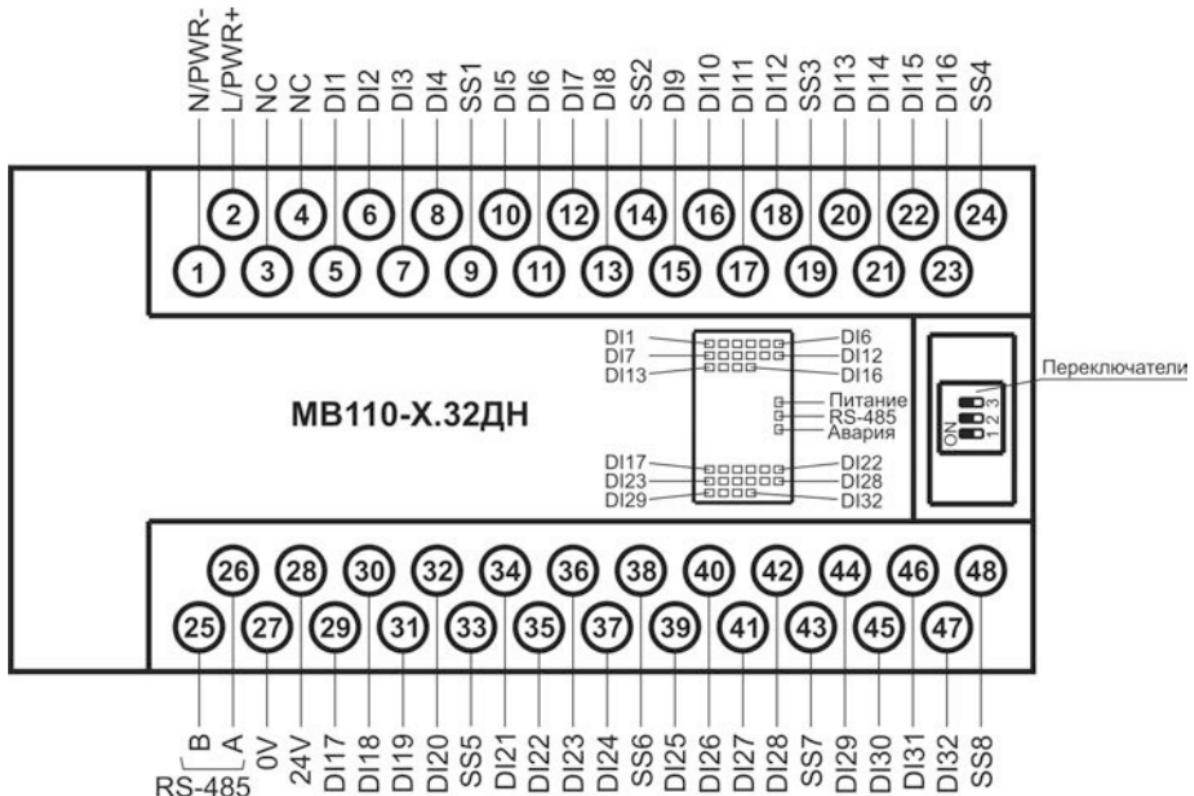
Рисунок Б.1 – Общий чертеж МВ110-32ДН
