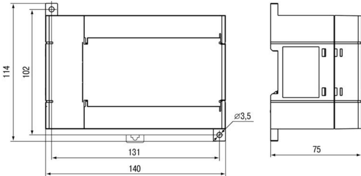
Рисунок А.1 – Габаритно-установочный чертеж MB110
