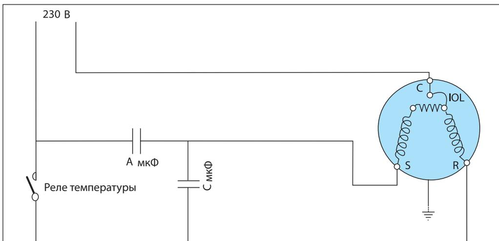
**Схема запуска типа CSR однофазного электродвигателя с цепью слабого тока**
