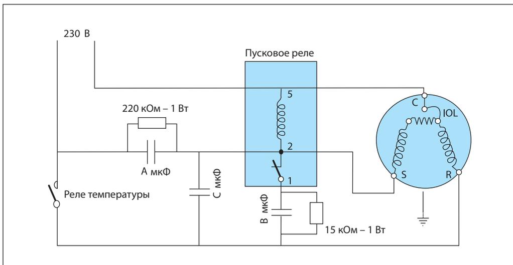
**Схема запуска типа CSR однофазного электродвигателя без цепи слабого тока**
