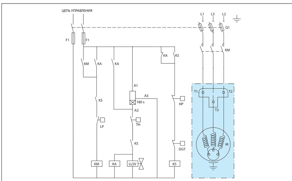
**Монтажная схема для цикла без вакуумирования**
