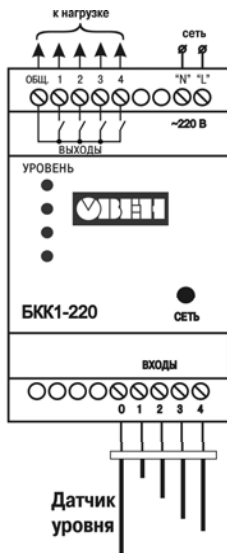
Рис. А.2. Схема подключения БКК1-220
