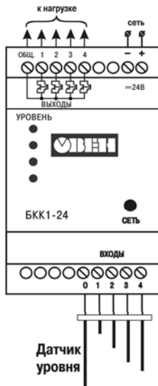
Рис. А.1. Схема подключения БКК1-24
