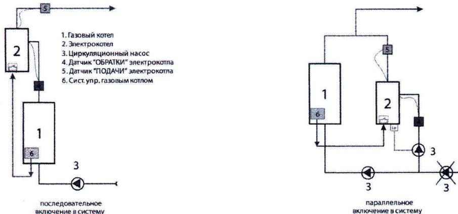
Рис. 11. Комбинированное отопление. Схемы подключения электрокотла.
