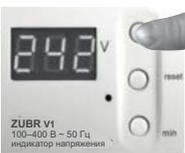
Для перегляду збереженої максимальної напруги натисніть на верхню кнопку. Відображення максимальної напруги буде супроводжуватися зеленим світінням індикатора. Через 3 с після останнього натискання кнопок, прилад повернеться до індикації напруги мережі, індикатор зеленого кольору згасне.
