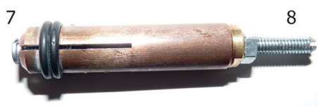
Медный наконечник с 4 прорезами для приваривания шпилек М4 (диаметр Ø 4 мм)
