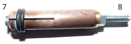
Boquilla en cobre a 4 grietas para soldar las clavijas M4 (diámetro Ø 4 mm)
