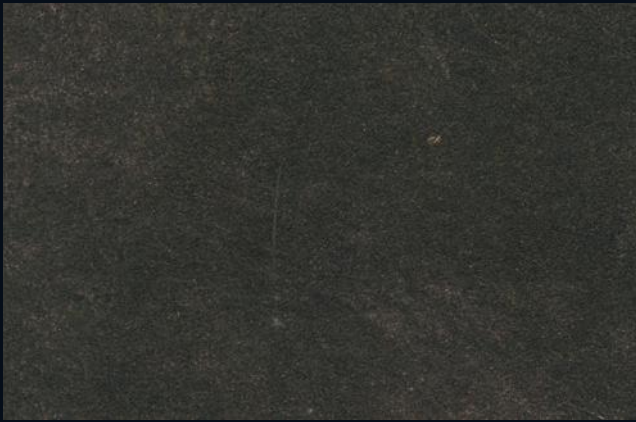
461 A + ADDITIVO SILVER G 200 KLONDIKE (LT. 1) + COLORÍ Col. 461 (6 ML.) + G 200 (LT. 0,100) KLONDIKE (LT. 2,5) + COLORÍ Col. 461 (15 ML.) + G 200 (LT. 0,250)
