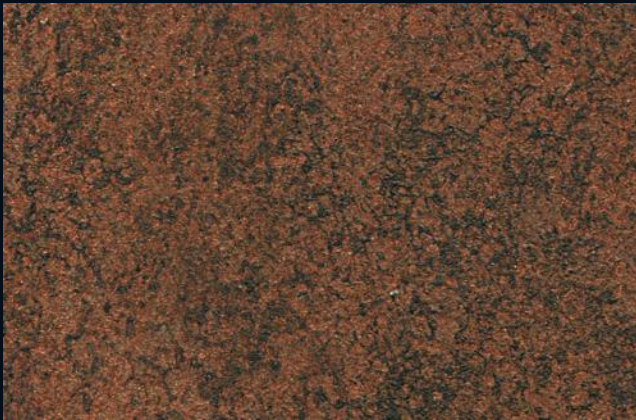
454 A + ADDITIVO GOLD G 100 KLONDIKE (LT. 1) + COLORÍ Col. 454 (6 ML.) + G 100 (LT. 0,100) KLONDIKE (LT. 2,5) + COLORÍ Col. 454 (15 ML.) + G 100 (LT. 0,250)
