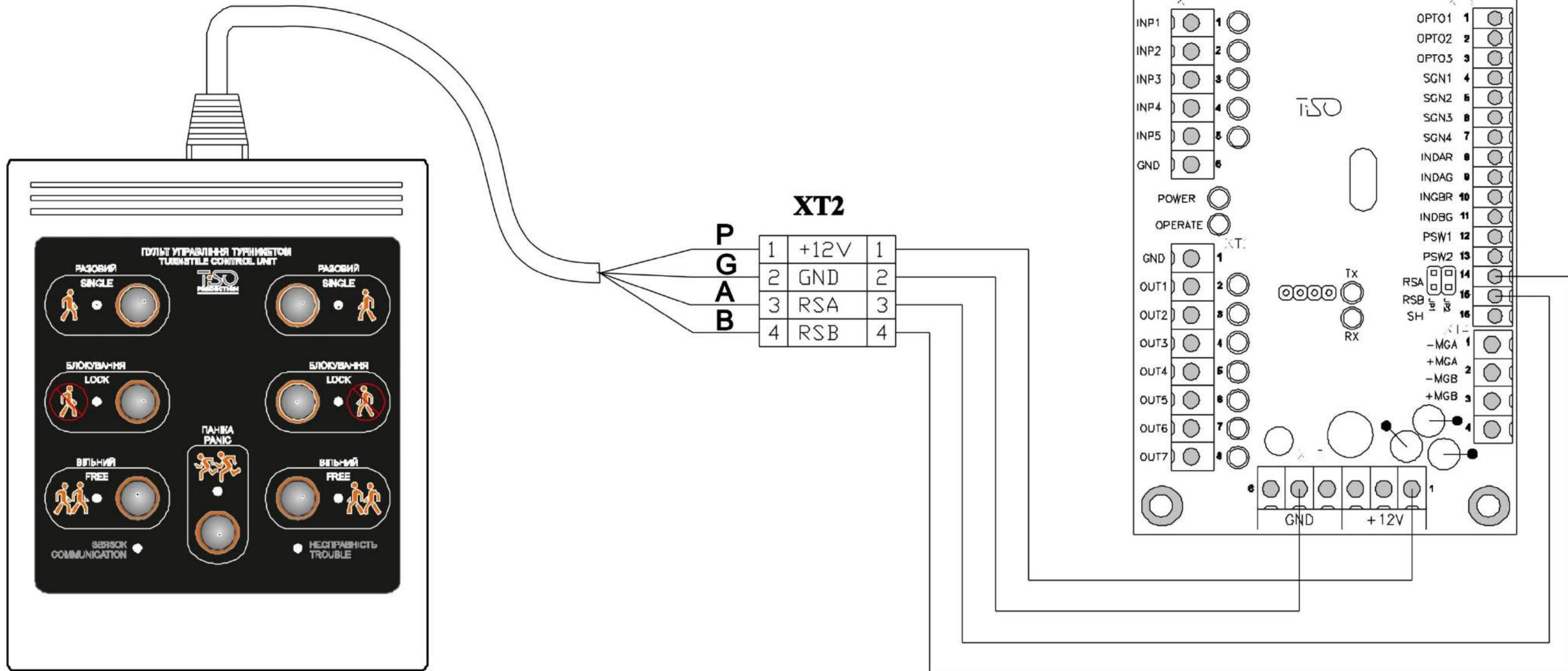
Рисунок Г.5 – Схема электрическая подключения турникета к пульту управления
