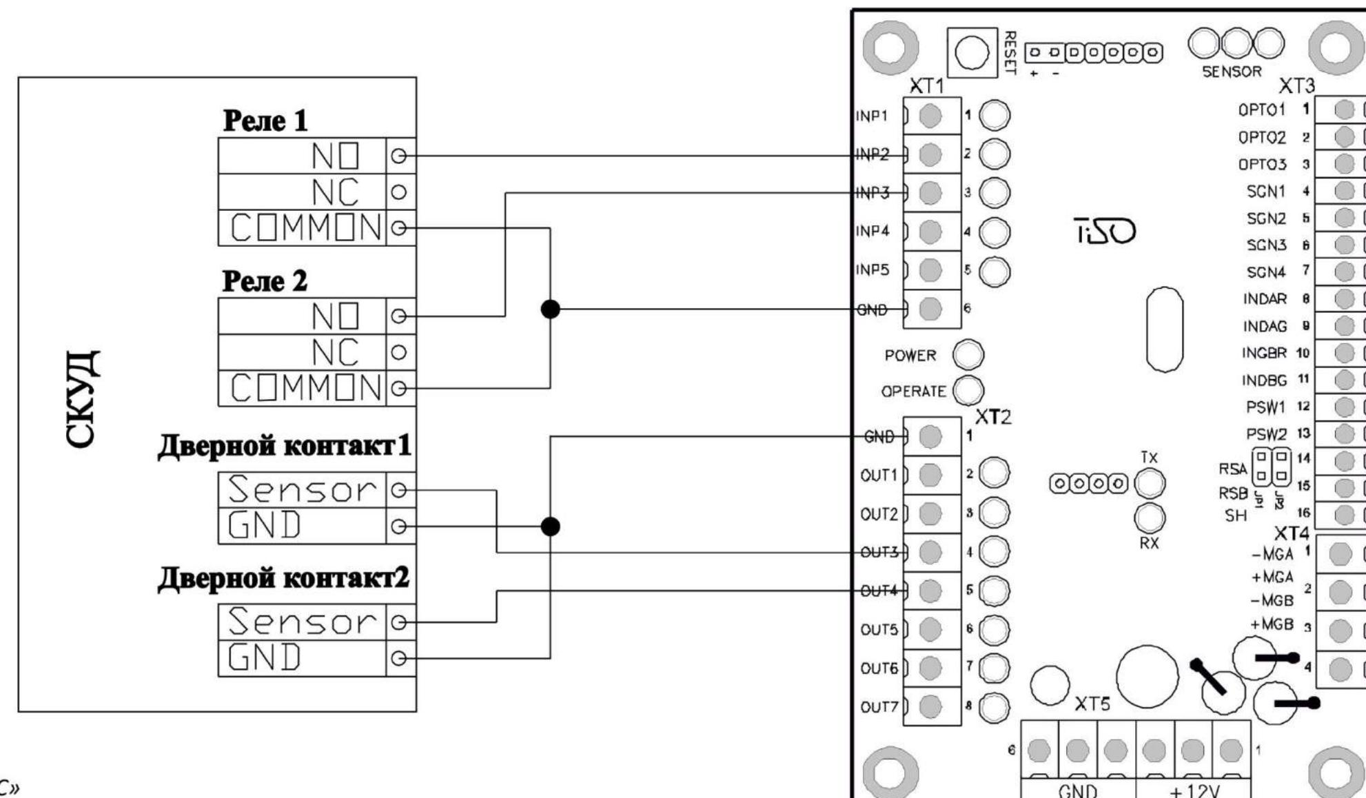
Рисунок Г.1 – Схема электрическая подключения турникета к СКУД
