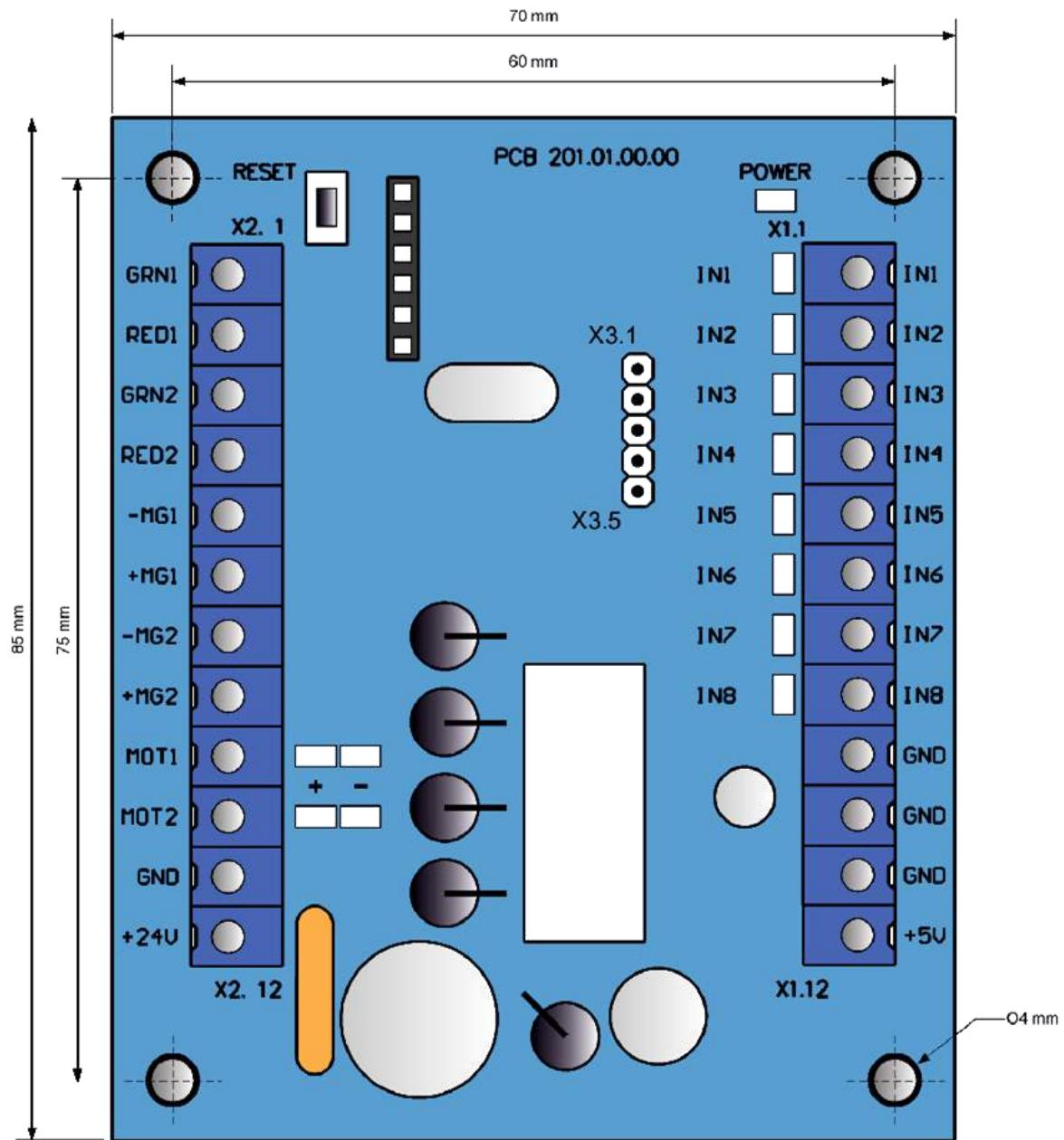
Рисунок 5 – Внешний вид контроллера моторизированного механизма PCB.201.01.00.00
