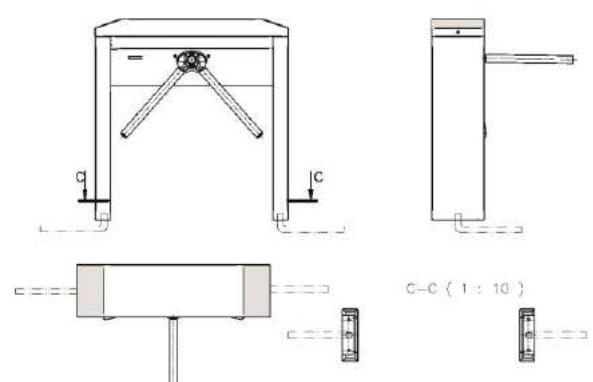
Рисунок 9 – Подвод кабелей турникета типа « трипод» в гофрированных или металлических трубах (условно)
