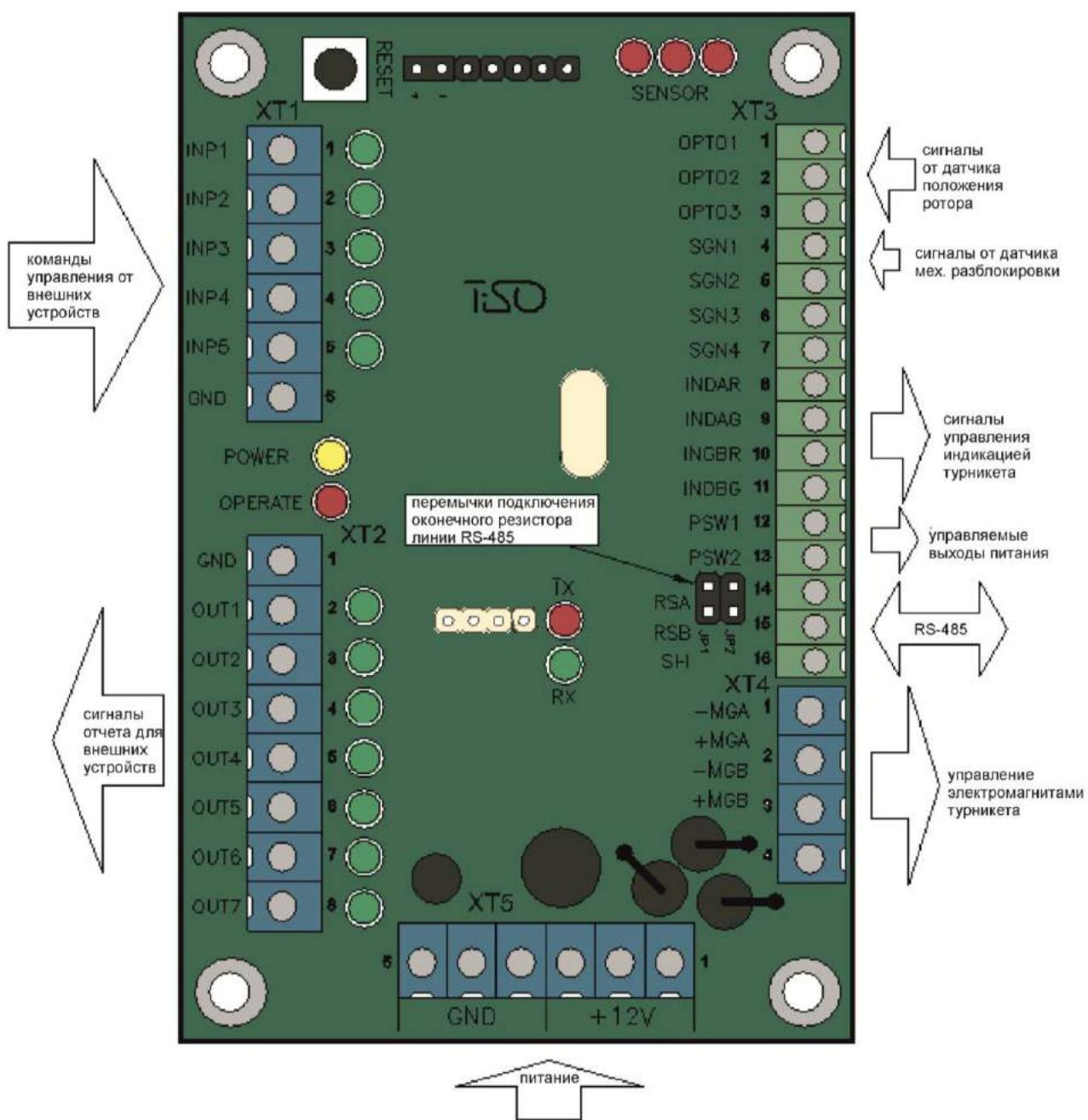
Рисунок 6 – Внешний вид контроллера турникета PCB.112.21.20.00
