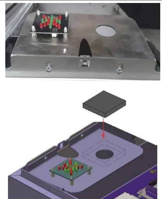
Рисунок 14– Место установка считывателя
