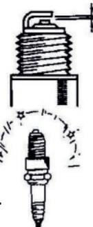
7.4. Перевірте і відрегулюйте зазор.
