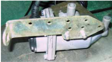
Рисунок 1. Крепление кронштейна к подогревателю
