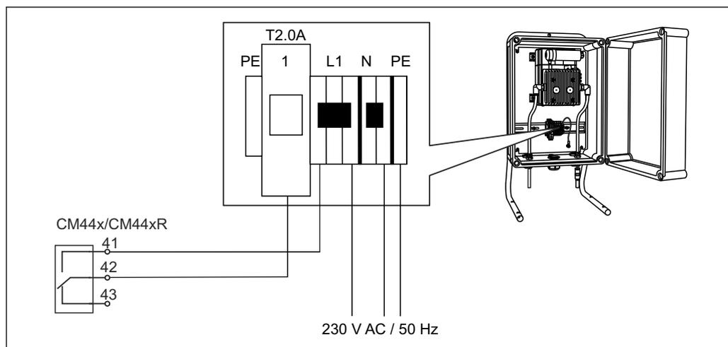
▣ 43 Подключение блока очистки для CAS40D
