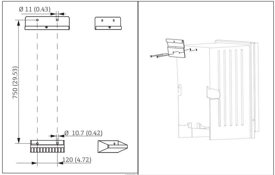
15 Размеры блока держателя. Единица измерения, мм (дюйм)
