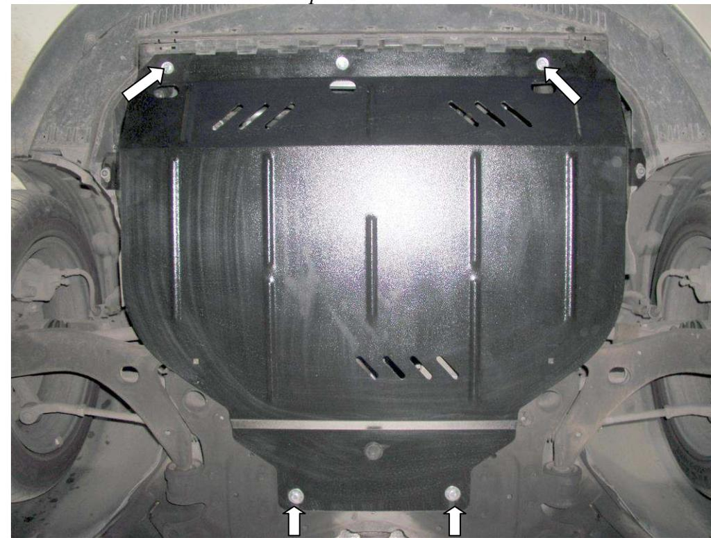
1. Снять штатный пыльник.
