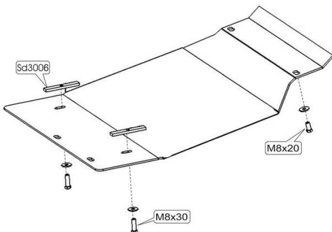
1. Установить закладные планки SD3006 в отверстия балки переднего моста.
