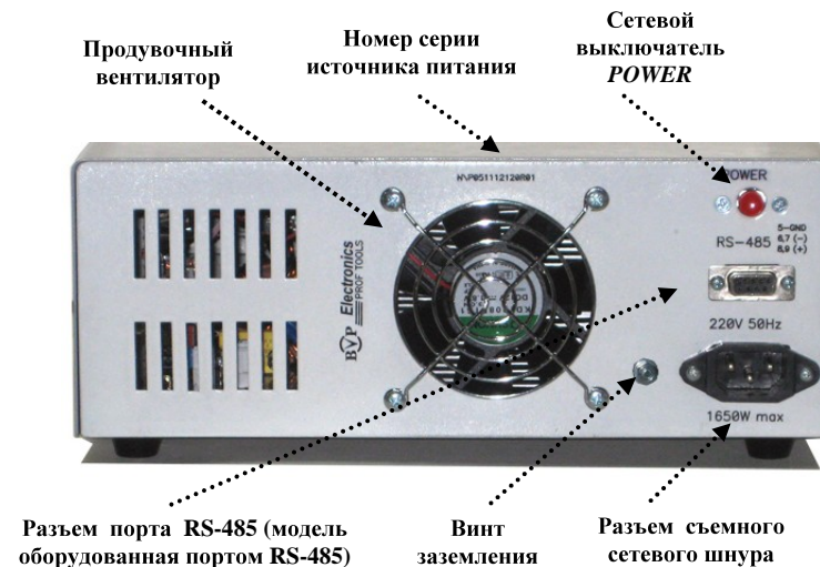
Рис. 3. Расположение органов управления на задней панели источника питания
