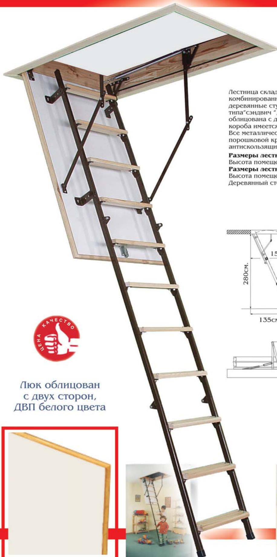
Лестница складная трехсекционная. Лестница комбинированная, металлические направляющие, деревянные ступени. Термоизоляционная крышка типа "сэндвич", толщиной 30мм, утеплена пенопластом, облицована с двух сторон ДВП белого цвета. По контуру короба имеется уплотнитель, высота короба 140мм. Все металлические элементы лестницы покрашены порошковой краской, ступени лестницы имеют антискользящие насечки. Нагрузка на ступень 150 кг.
