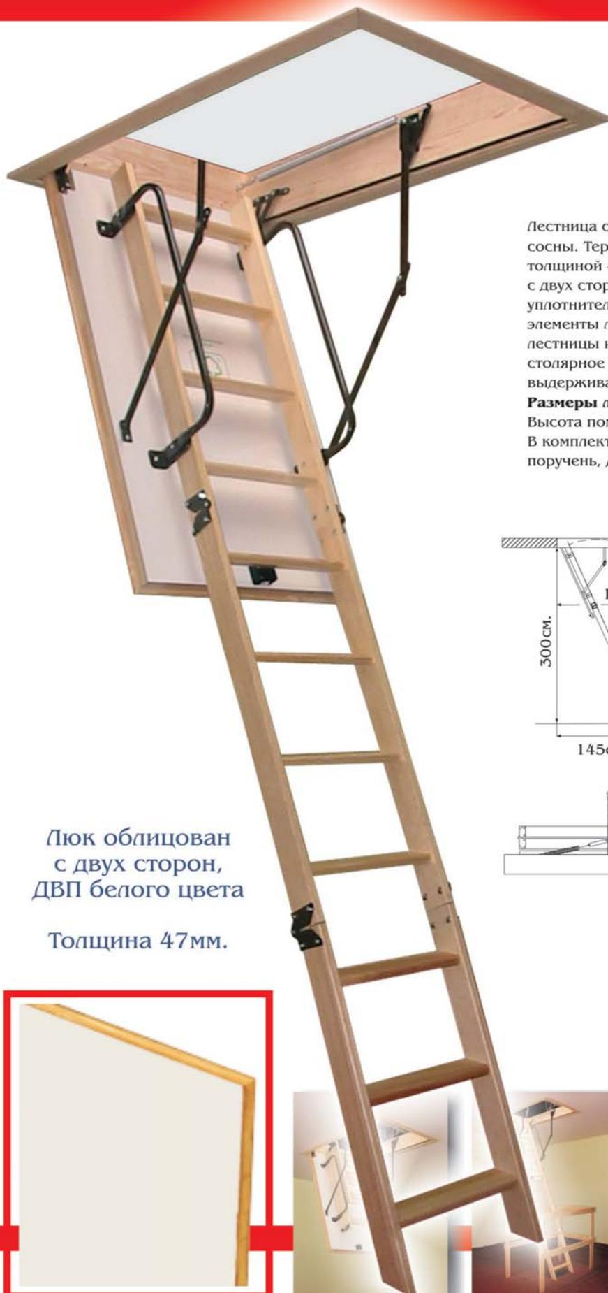
Лестница складная четырехсекционная, изготовлена из сосны. Термоизоляционная крышка типа "сэндвич" толщиной 47мм, имеет усиленную теплозащиту, облицована с двух сторон ДВП белого цвета. По контуру короба имеется уплотнитель, высота короба 170мм. Все металлические элементы лестницы покрыты порошковой краской, ступени лестницы имеют антискользящие насечки и закреплены в столярное соединение «ласточкин хвост», что позволяет выдерживать нагрузку 150 кг.
