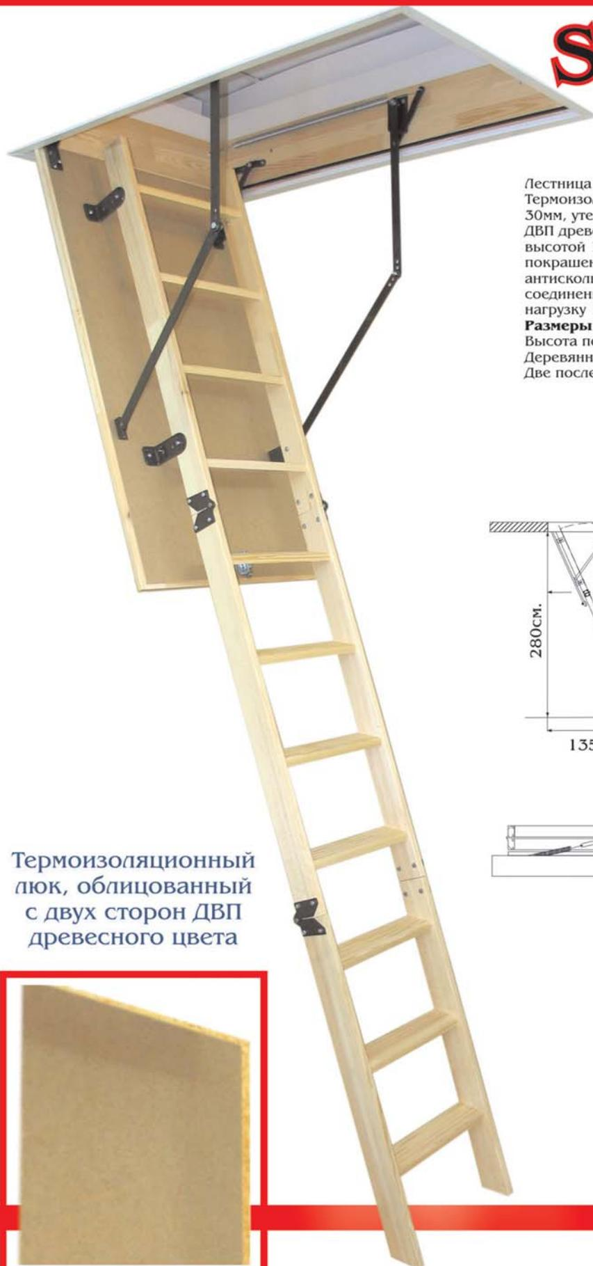
Лестница складная трехсекционная, изготовлена из сосны. Термоизоляционная крышка типа "сэндвич", толщиной 30мм, утеплена пенопластом, облицована с двух сторон ДВП древесного цвета. Короб люка с уплотнителем, высотой 140мм. Все металлические элементы лестницы покрашены порошковой краской, ступени лестницы имеют антискользящие насечки и закреплены в столярное соединение «ласточкин хвост», что позволяет выдерживать нагрузку 150 кг.
