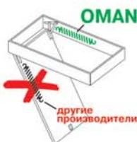
Безопасность лестницы обеспечивает уникальный механизм крепления пружин в коробе.
