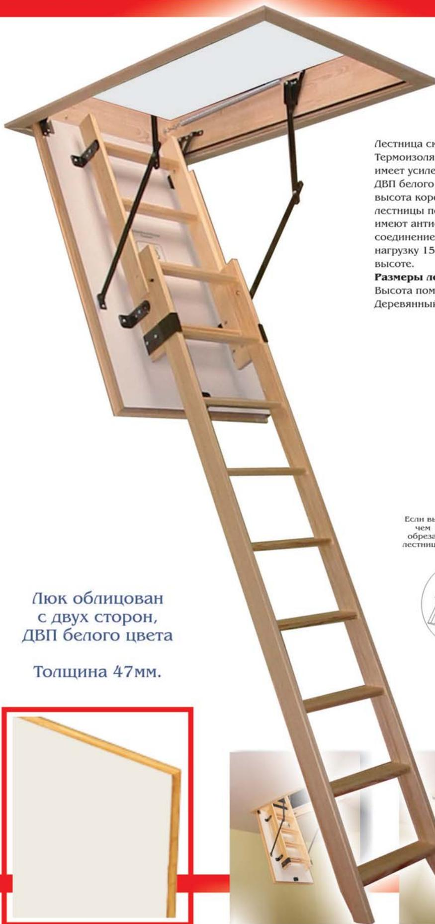
Лестница складная двухсекционная, изготовлена из сосны. Термоизоляционная крышка типа "сэндвич" толщиной 47мм, имеет усиленную теплозащиту, облицована с двух сторон ДВП белого цвета. По контуру короба имеется уплотнитель, высота короба 170мм. Все металлические элементы лестницы покрыты порошковой краской, ступени лестницы имеют антискользящие насечки и закреплены в столярное соединение «пасточкин хвост», что позволяет выдерживать нагрузку 150 кг. Удобна для эксплуатации на большой высоте.
