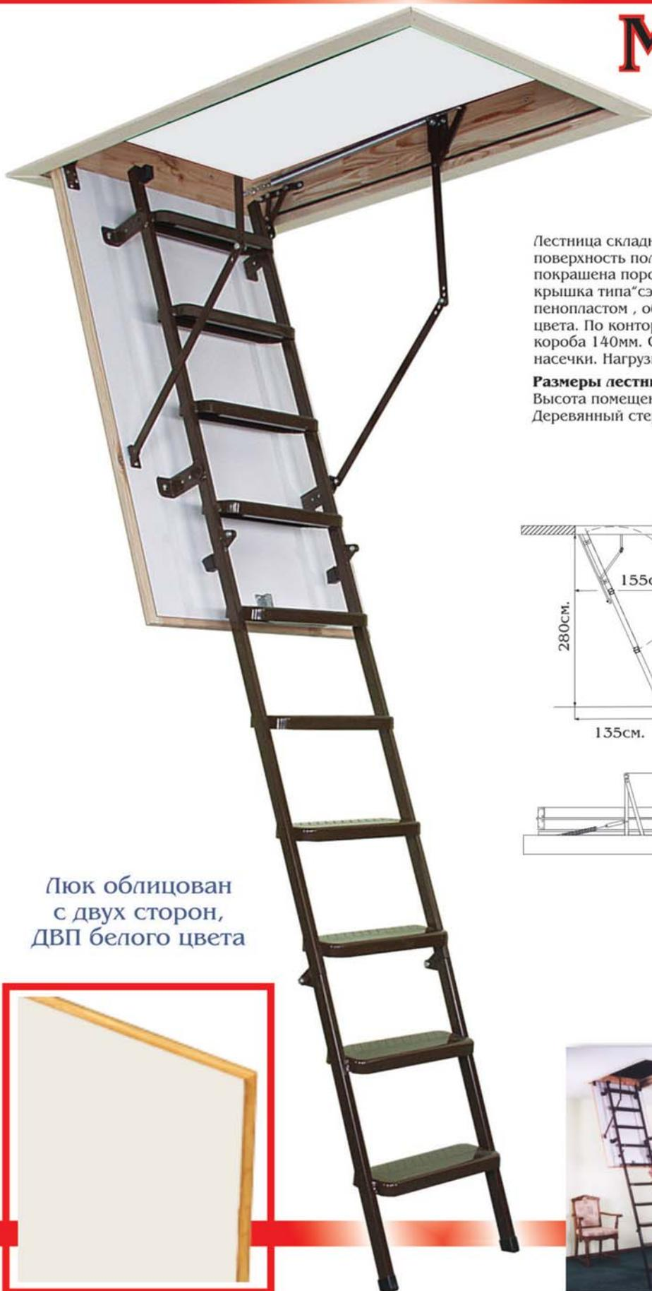
Лестница складная трехсекционная. Рабочая поверхность полностью выполнена из металла и покрашена порошковой краской. Термоизоляционная крышка типа "сэндвич", толщиной 30мм, утеплена пенопластом, облицована с двух сторон ДВП белого цвета. По контуру короба имеется уплотнитель, высота короба 140мм. Ступени лестницы имеют антискользящие насечки. Нагрузка на ступень лестницы 150кг.
