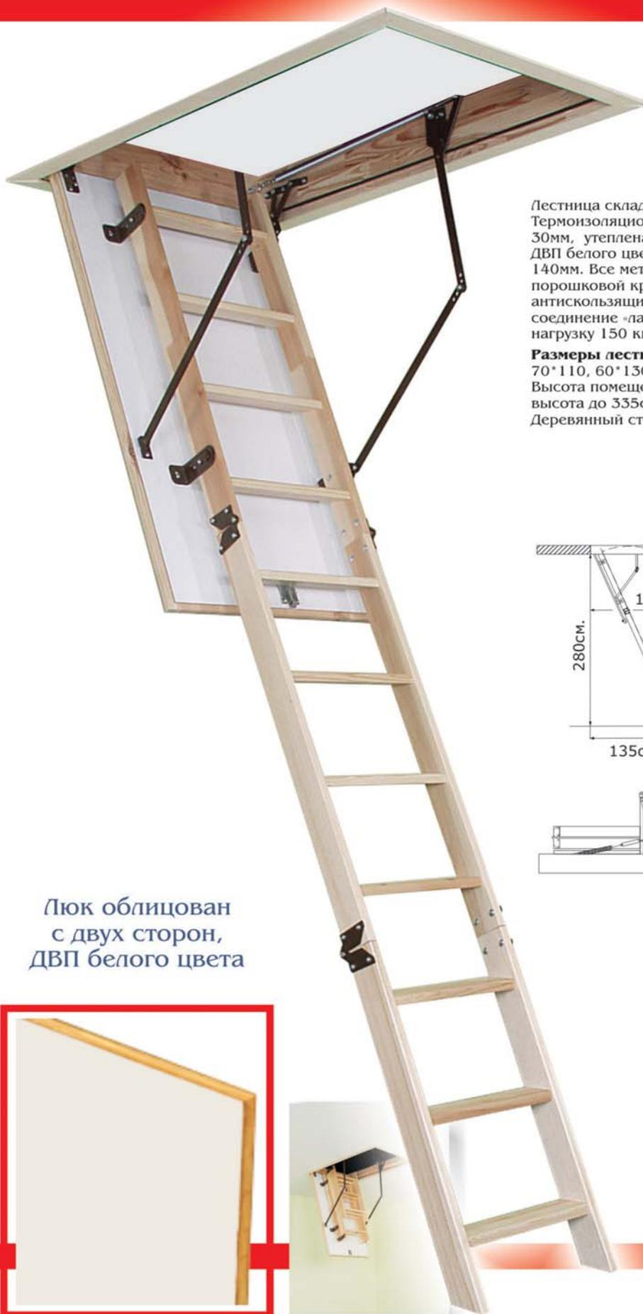
Лестница складная трехсекционная, изготовлена из сосны. Термоизоляционная крышка типа "сэндвич", толщиной 30мм, утеплена пенопластом, облицована с двух сторон ДВП белого цвета. Короб люка с уплотнителем, высотой 140мм. Все металлические элементы лестницы покрыты порошковой краской, ступени лестницы имеют антискользящие насечки и закреплены в столярное соединение «ласточкин хвост», что позволяет выдерживать нагрузку 150 кг.
