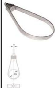
Крепления к профнастилу. Монтируется как на резьбовую шпильку, так и при помощи саморезов. Имеются разновидности с приваренной гайкой M8/10. Покрытие: гальваническое покрытие цинком. Стальной профиль 25 x 2,5 мм (B x S). Производитель: MEFA (Германия)
