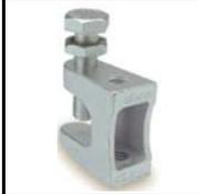
4H58 - это забивная скоба с проушиной для быстрого монтажа на двутавр или уголок. Идеальна для подвешивания средних грузов. Статическая нагрузка 70 или 90 кг. Не требует сверления металлоконструкции. Производитель: Erico (Германия)
