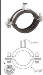
Петлевой хомут "Erico" FCS для монтажа спринклерных и дренажных систем пожаротушения. Имеет сертификацию институтов VdS, FM, cUL. Диапазон диаметров от 1/2" до 10" включительно. В комплекте сразу идет петля, гайка-стакан и фиксирующая контр-гайка. - Надежный монтаж благодаря цельной конструкции; - Крепится на шпильку; - Прилагаются контргайки; - Покрытие: гальваническое покрытие цинком; - Одобрено VdS, модель M10 одобрена FM; - Для труб диаметром от 1/2" до 10". Производитель: Erico (Германия)
