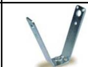
Монтажная трубка (клемма) TKN предназначена для бессварочного монтажа на угловые и тавровые несущие конструкции. Рассчитана на серьезные нагрузки и одобрена институтами VdS и FM для монтажа систем пожаротушения. - Для крепления на балке без сварки или сверления; - Компактный литой корпус; - Болт с выемкой на конце обеспечивает улучшенное сцепление; - Покрытие: гальваническое покрытие цинком. Производитель: Германия
