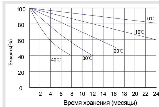
График показывает на сколько падает емкость аккумулятора при хранении в определенных условиях и в определенный промежуток времени
