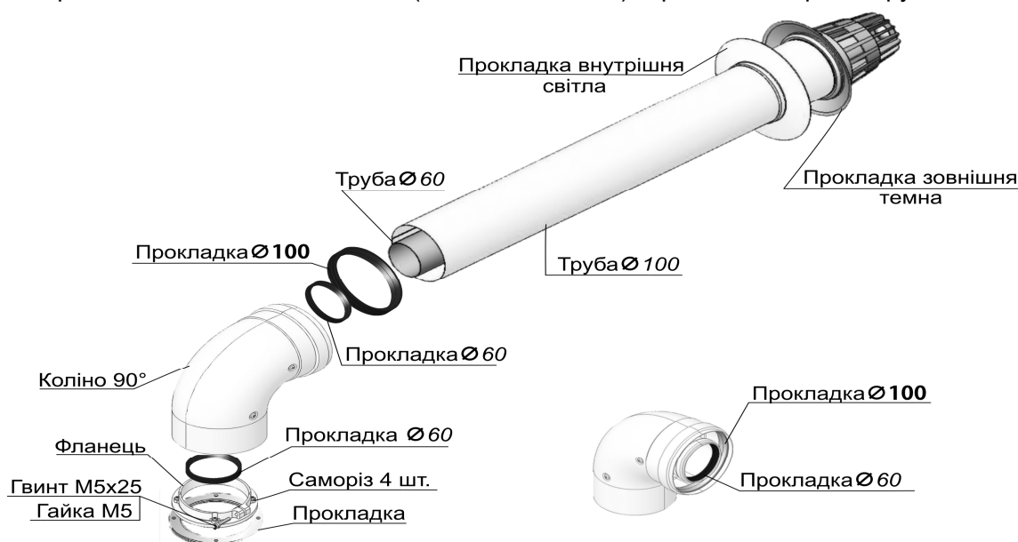
Рисунок 9. Схема монтажу коаксиальної системи газоповітроходу
