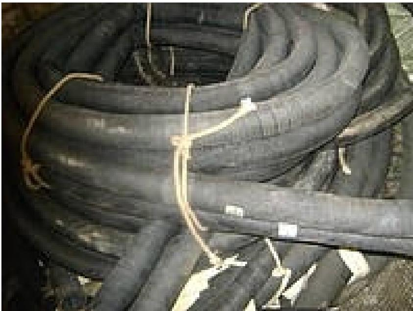
Рукава для подачи горячей воды, а также пара под давлением для проведения горячей чистки и стерилизации на предприятиях, для отвода горячего пара с промышленного оборудования применяют специальные резиновые рукава -
