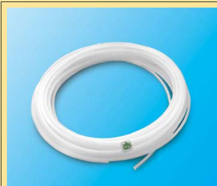
Термостойкая пневмотрубка PTFE используется для прокладки линий пневмопитания через зоны с высокой температурой или содержанием агрессивных веществ. Материал PTFE (тефлон) является самым устойчивым пластиком к воздействию агрессивных веществ (кислоты, щелочи, пары) на сегодняшний день. Пневматический шланг PTFE обладает практически идеальными диэлектрическими свойствами, устойчив к воздействию озона и ультрафиолетовых лучей.
