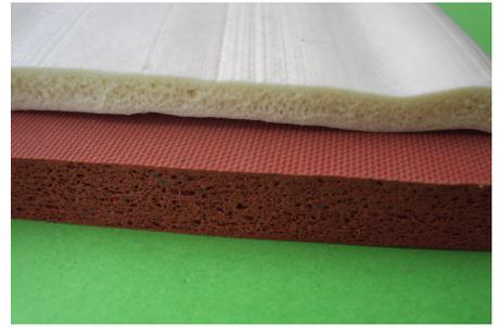
Тепло-, морозостойкие профили используются в качестве уплотнителей в интервале температур от  $-50^{\circ}\text{C}$  до  $+200^{\circ}\text{C}$ .
