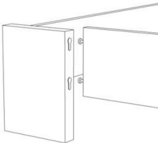
Для сборки деталей корпуса этой кровати в основном используются клинообразные соединения. Нужно вставить одну деталь в другую, с силой нажать на торец вниз до упора и детали собраны. Если Вам кажется что детали стянулись между собой не достаточно плотно, то достаточно подтянуть винты крестообразной отвёрткой на полоборота и повторить сборку.
