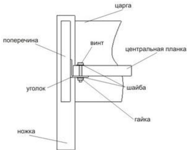
Установите центральную планку на уголки и скрепите их между собой используя винт, шайбы и гайку, как показано на рисунке.
