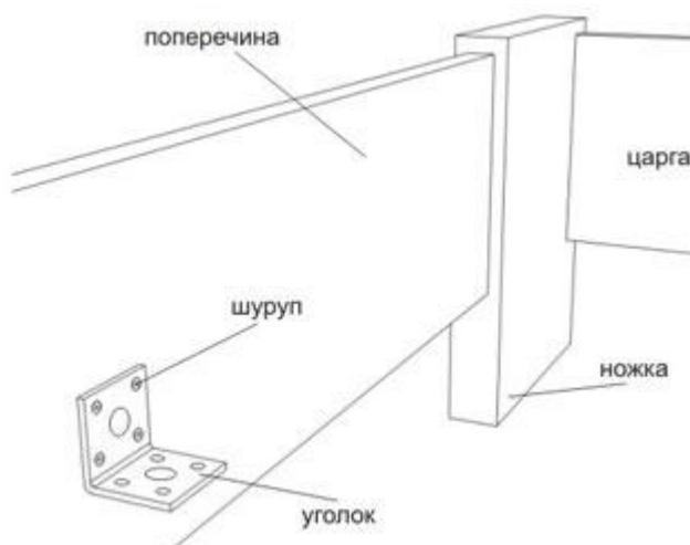
Найдите на поперечине предварительно засверленные отверстия и используя крестообразную отвёртку и входящие в комплект шурупы прикрепите к поперечине металлический уголок так, как показано на рисунке.
