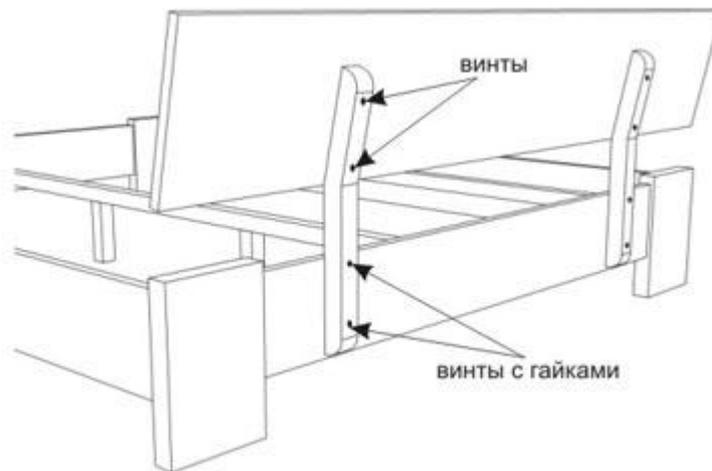
Для крепления спинки к поперечине используются стойки (из стали или дерева в зависимости от комплектации) которые в свою очередь крепятся винтами к спинке и винтами с гайками к поперечине.
