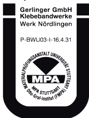
Selbstklebende Aluminiumbänder Gerband 705, 706, 712, 715/8, 725 DIN 4102 Klasse A2 Baustoffklasse nichtbrennbar, wenn auf metallischen Untergrund verklebt.
