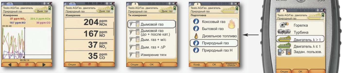
5. Документирование ← 4. Измерение ← 3. Выбор типа измерения ← 2. Выбор топлива ← 1. Выбор области применения
