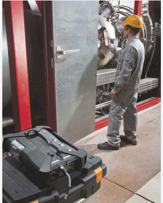
**Testo рекомендует данный комплект для измерения выбросов на различных стадиях тепловых процессов**
