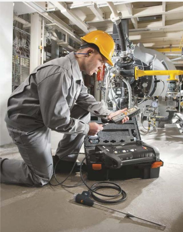
**Testo рекомендует данный комплект для измерения выбросов на промышленных горелках**
