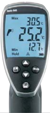
Вид дисплея во время инфракрасных измерений: текущее значение, мин./макс. значения
