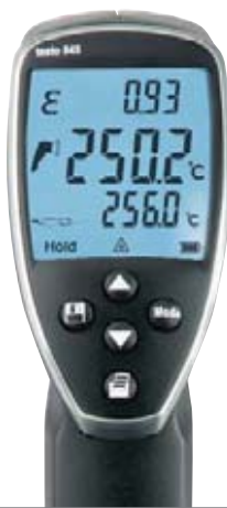
Вид дисплея при подключенном контактном зонде °C температуры: коэф.излучения, текущие значения °C инфракрасного измерения и °C контактного измерения
