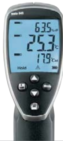
Вид дисплея при подключенном модуле влажности: текущее значение %ОВ, °C и °C р измеренные модулем влажности
