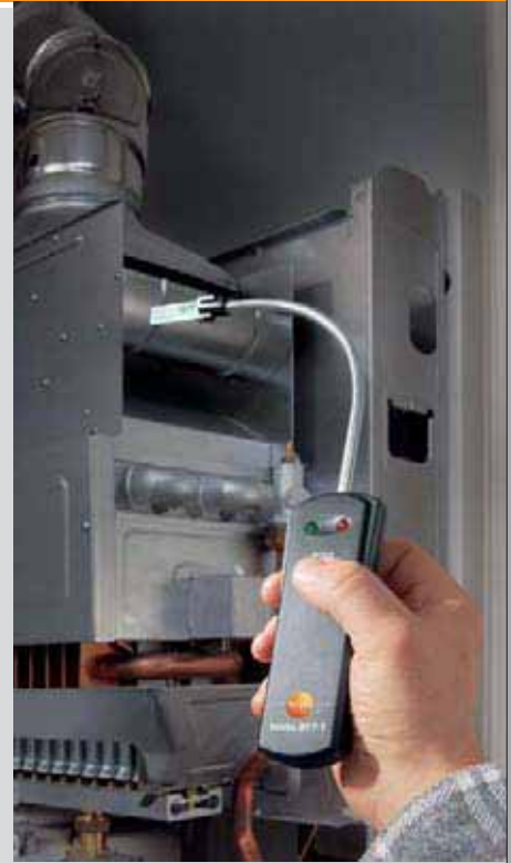
Устанавливает, полностью ли дымовые газы удаляются из камеры сгорания
