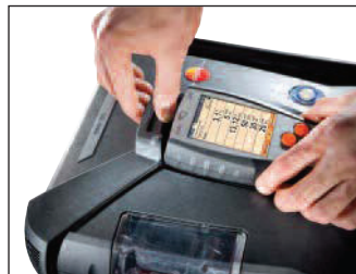
Управляющий модуль просто "защелкивается" в блок анализатора
