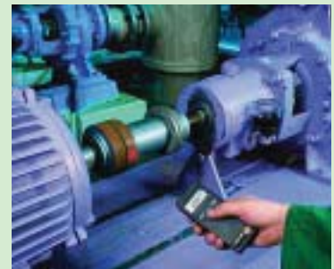
Измерения об/мин на насадках, валах с помощью testo 465
