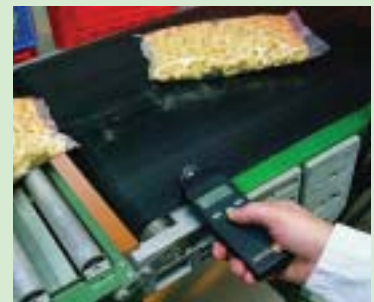
Измерения скорости/длины с использованием testo 470
