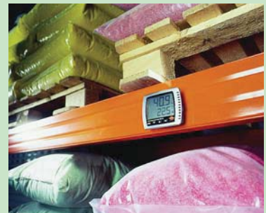
Точный мониторинг условий хранения на складах с погрешностью \pm 2\% ОВ
