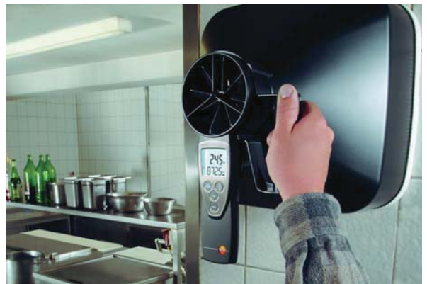
testo 417, используется, например, для мониторинга отработанного воздуха в настенных вентиляторах
