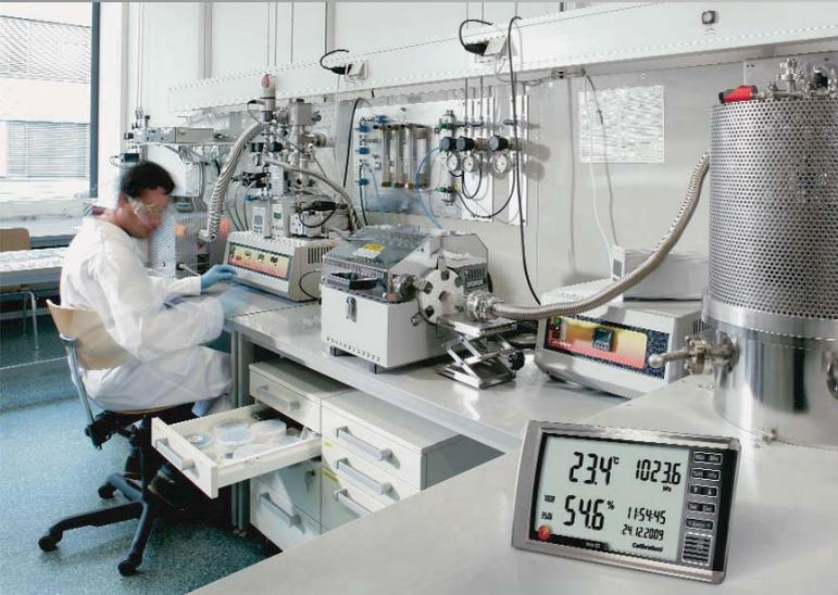
Для быстрого считывания данных температуры и влажности с указанием даты и времени достаточно одного взгляда на дисплей testo 622. Помимо этого, Вы можете выполнить настройку и калибровку измерительного прибора с помощью ПО для настройки и калибровки, что позволит Вам сэкономить время и избежать дополнительных затрат.
