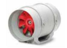
Диагональная крыльчатка, 8 загнутых лопаток из термопласта. Низкий уровень вибраций благодаря динамической балансировке крыльчатки согласно классу точности G 6.3 VDI 2060 и нормам DIN ISO 1940.
