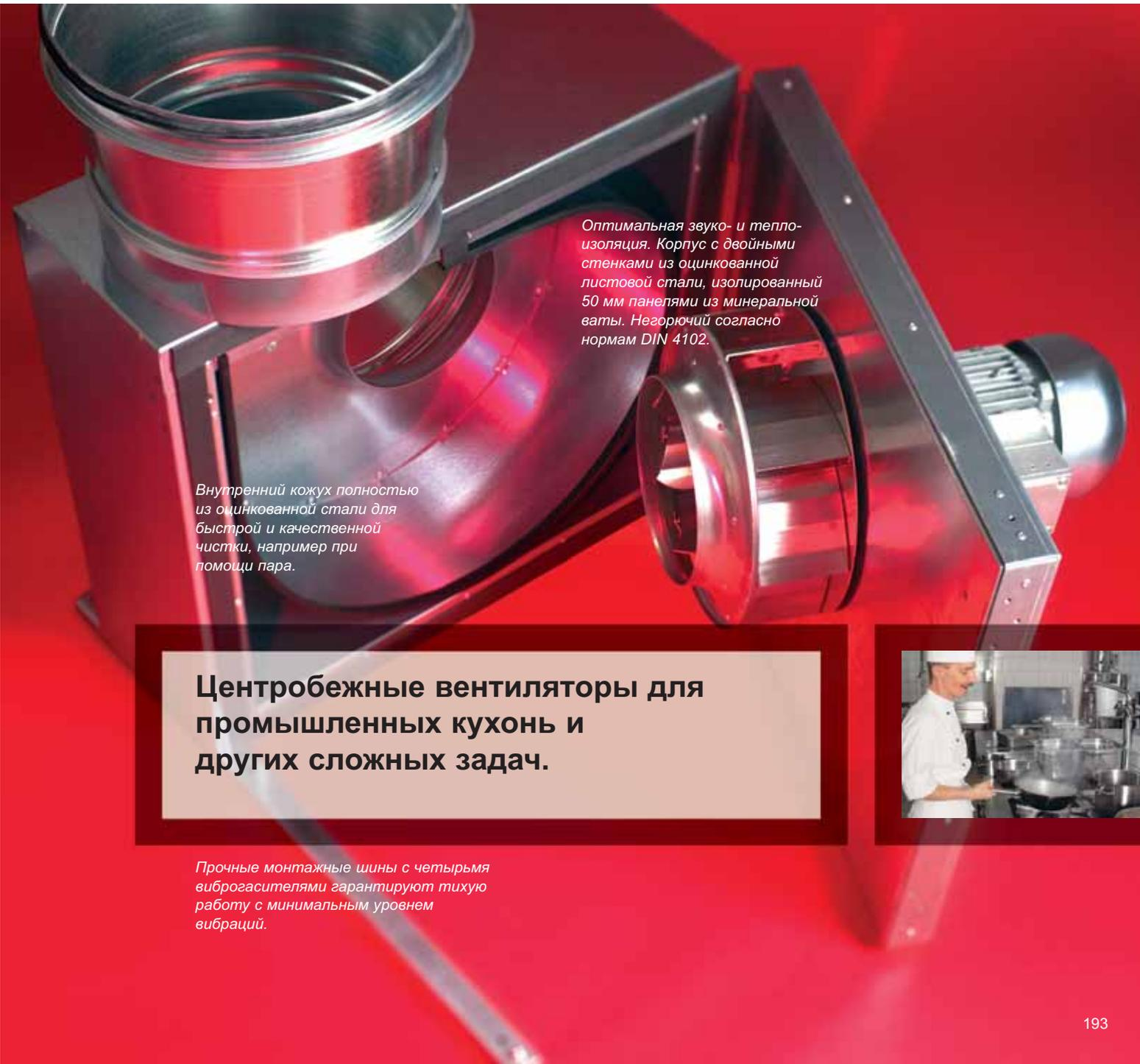
*Оптимальная звуко- и тепло-изоляция. Корпус с двойными стенками из оцинкованной листовой стали, изолированный 50 мм панелями из минеральной ваты. Негорючий согласно нормам DIN 4102.*
