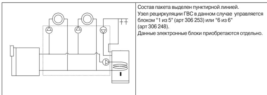
Схема установки пакетов системы быстрого монтажа
